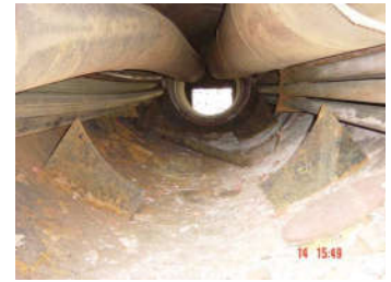
สภาพท่อไฟใหญ่ที่ฉีกขาดบริเวณรอยเชื่อมยึด ผนังหน้าและผนังหลัง
